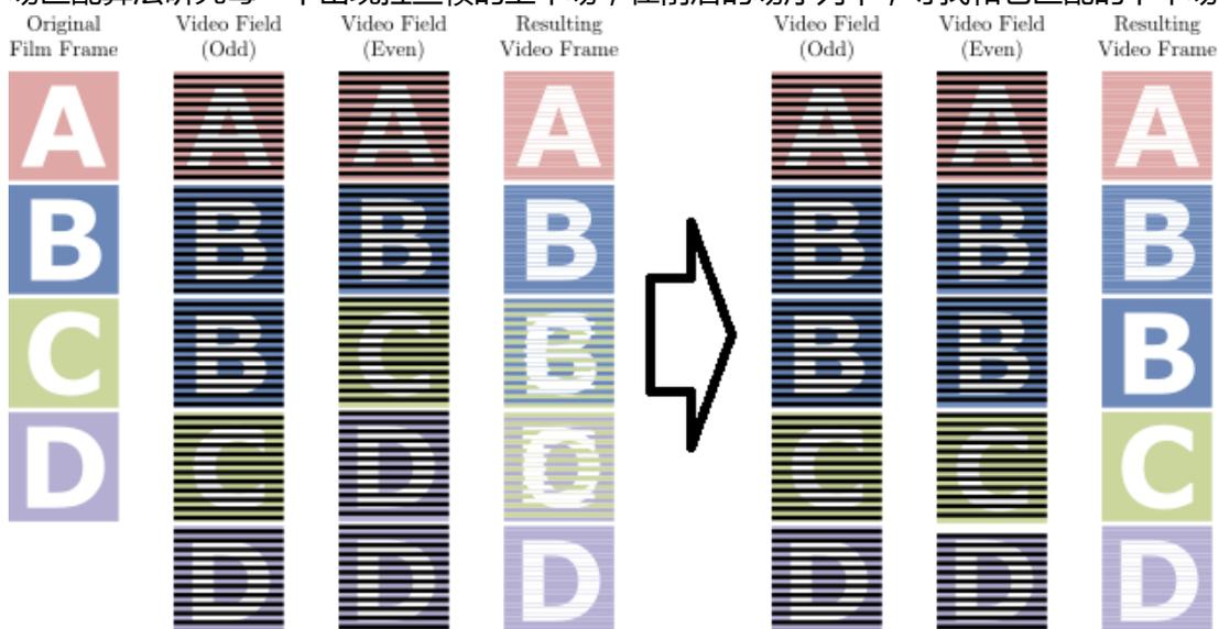
经过场匹配后，出现拉丝的两帧，下半场和上半场就可以完美匹配成单一的图像。输出的图像从有拉丝的 24t，变成了没有拉丝，只有重复帧的 24d。
